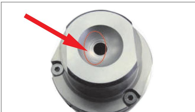
Abb. 2: Beschädigte Heißkanaldüse aufgrund einseitiger Anlage der Maschinendüse auf einem schmalen Ring. Die geringe Kontaktfläche erlaubt nur eine eingeschränkte Wärmeübertragung.
